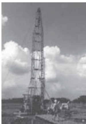
Figura III.5.5. Sistema de perforación de rotación con circulación directa.
