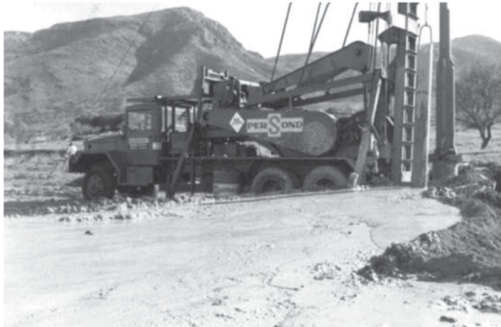
Figura III.5.3. Maquinaria para llevar a cabo una perforación a percusión.
